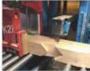
3-Achse-Schneidfräse mit 3 Werkzeugen
